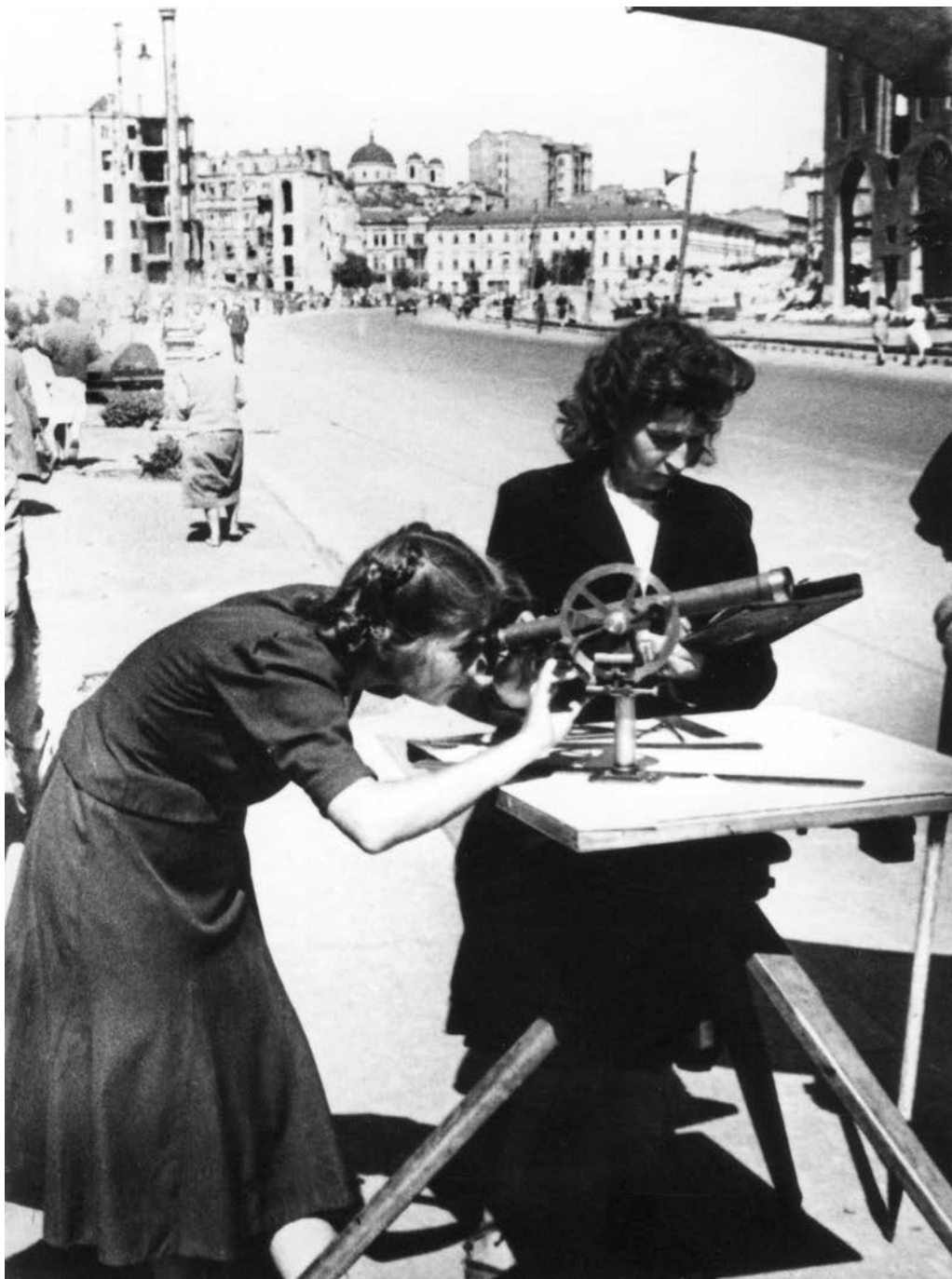
Топографи А. Ніколаєва та В. Хавкун ведуть зйомку Хрещатика за допомогою кіпрегеля 1944 рік
